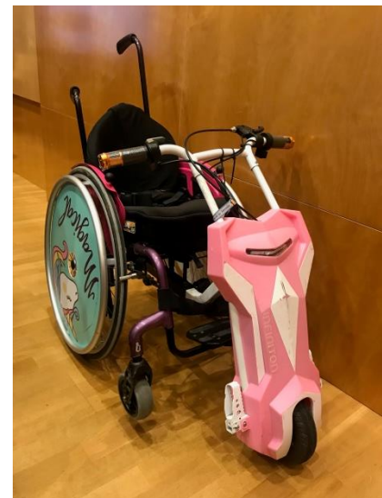
Silla de ruedas infantil con handbike low-cost acoplado, adaptado a partir de un scooter drift
